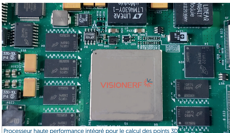
Processeur haute performance intégré pour le calcul des points 3D
